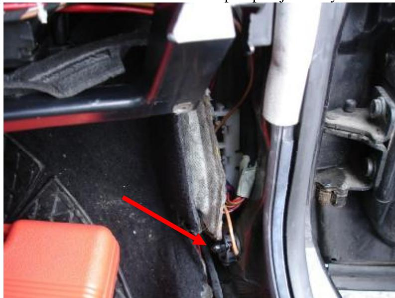
Koberec je pod sedačkou dosť ohybný dá sa nadvihnuť a pod ním to biele je rozpojené a dá sa tade pekne pretlačiť kábel až k tej rúrke pod sedačkou, kde je prívod na airbag. Káble boli dosť dlhé ešte som z nich trošku odrezal a konektor som napinoval nanovo.
