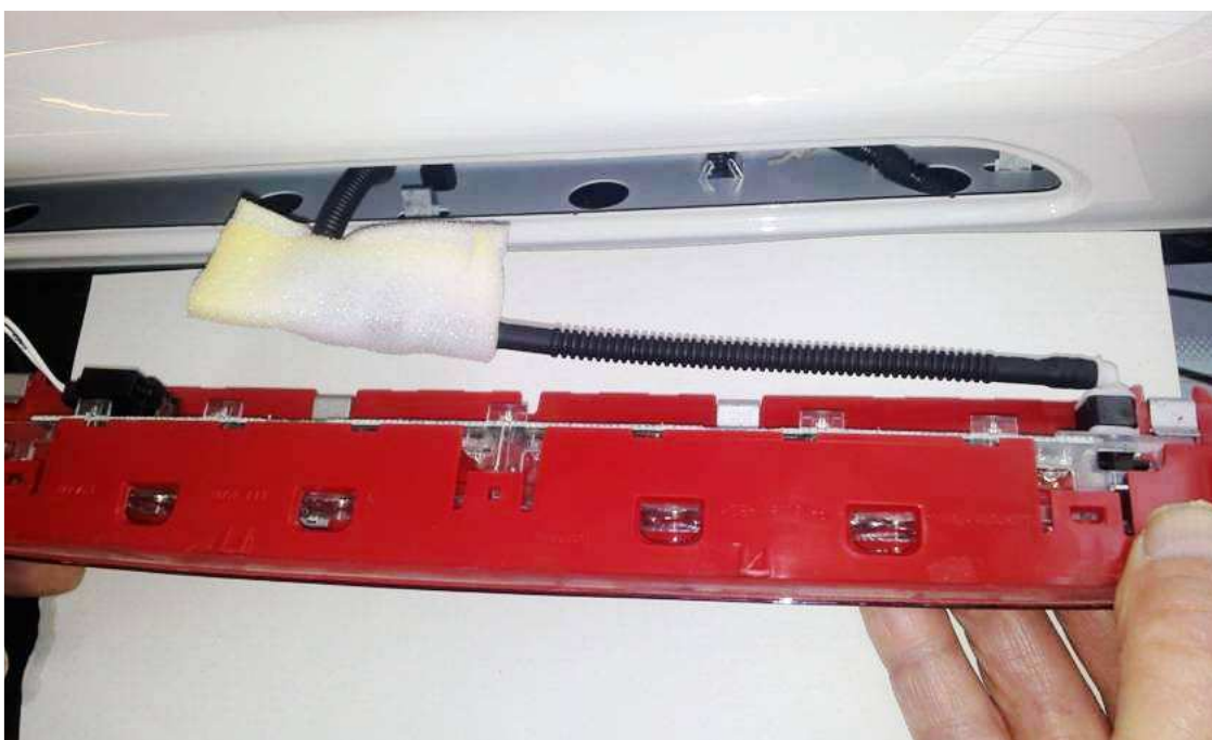
Obrázek 4) Příklad Golf: Příklad Golf: Přídavná brzdová svítlna s hadicí, zpětným ventilem a samolepicí pěnovkou (č. OD: 1J0 971 798 C).
